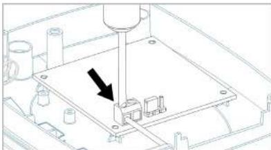
Nachdem das Netzkabel eingesteckt und angeschlossen wurde, befestigen Sie es mit dem mitgelieferten kleinen Kabelbinder und schließen Sie das Gerät mit den 4 mitgelieferten Schrauben.
